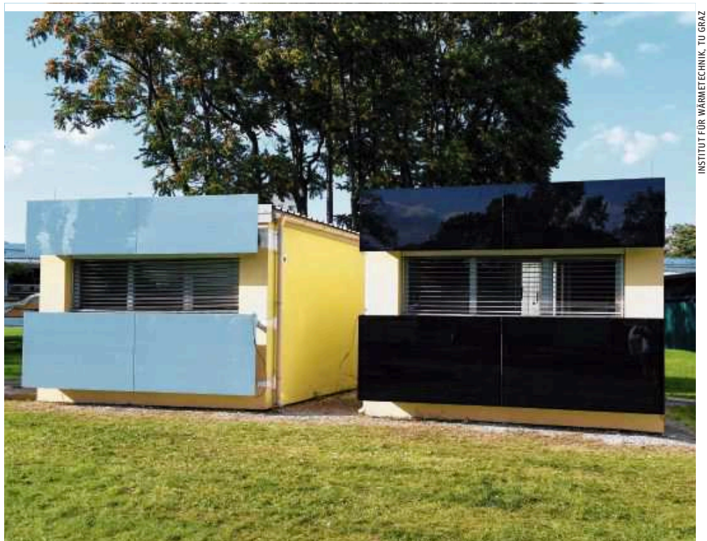
Coolskin nutzt Sonnenenergie zur Kühlung – genau dann, wenn der Bedarf am stärksten ist
